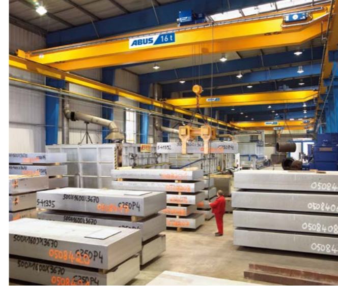
Dubbelrail-katten type D op dubbelligger loopkranen.
